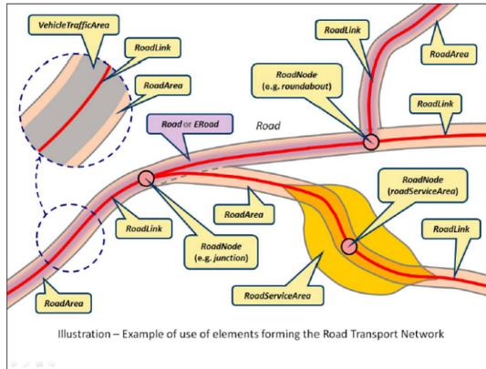
Abbildung 2: reines Straßennetz (aus: INSPIRE Data Specification on Transport Networks - Guidelines)
