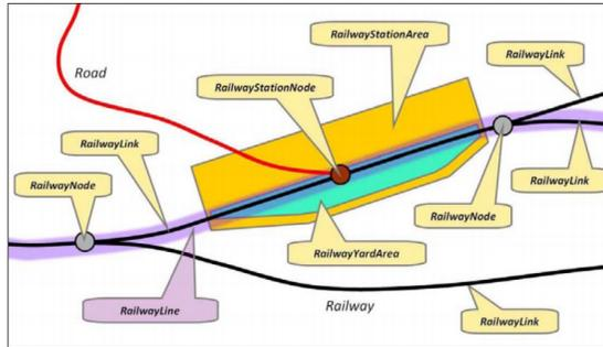
Abbildung 1: Intermodale Verkehrsnetze, hier: ein Übergang zwischen Schienen- und Straßenverkehrsnetz (aus: INSPIRE Data Specification on Transport Networks - Guidelines)
